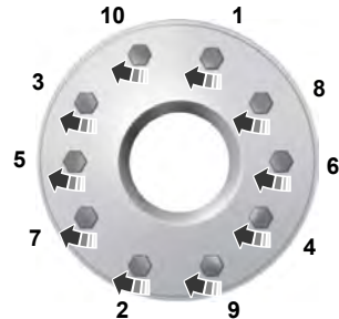
10-lug nut torque sequence
